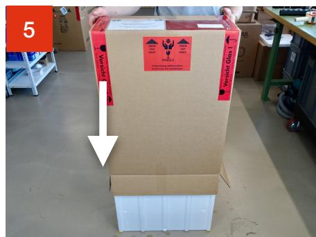
Bedienungsanleitung oben auflegen und Karton von oben über die Styroporteile stülpen.
