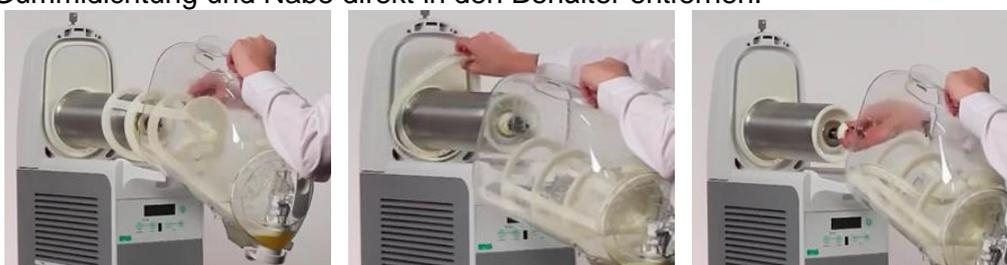
**c:** Sicherungstift vorsichtig entfernen und den Zapfhahn nach oben herausziehen. Anschliessend die Maschine mit Reinigungslösung gut Reinigen.
