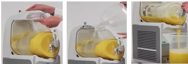
**3.** Die Maschine ausschalten. Hauptschalter auf Aus. Netzstecker herausziehen. Das Gerät gemäss Video komplett demontieren: [https://www.youtube.com/watch?v=Tg\\_Za3Lg9tQ](https://www.youtube.com/watch?v=Tg_Za3Lg9tQ).
