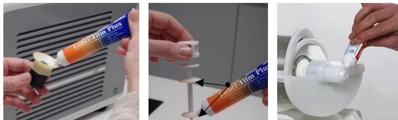
**b:** Gummidichtung anbringen und rundum gut festdrücken. Gefettete Nabe aufstecken. Schnecke über den Kühlzylinder anlegen. Den Behälter darüberschieben und andrücken bis es "klick" macht.
