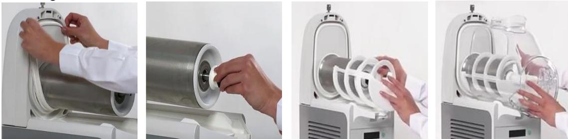
**c:** Den Dossierhahn von oben einführen und mit dem Sicherungstift arretieren. Durchflussbegrenzer wieder montieren.
