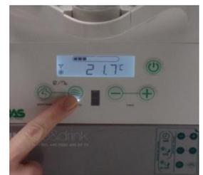
**2.** Entfernen sie den Behälterdeckel. Geben sie 4L lauwarmes Wasser mit Spülmittel direkt in die Maschine. Danach im Reinigungsmodus ein paar Minuten durchlaufen lassen, bis sich der ganze Emmi Glace Frischmix aufgelöst hat. Dann das Schmutzwasser durch den Dosierhahn komplett ausgiessen.
