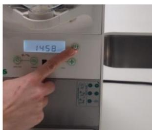
3. Appuyez environ 3 secondes sur le bouton On, jusqu'à ce que la machine se mette à tourner.
