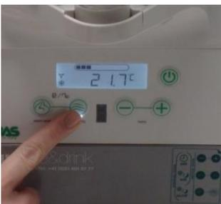
6. Une fois la soirée terminée, vous pouvez régler sur mode nuit afin d'économiser de l'énergie. La machine refroidit automatiquement à une température de 2°C.
