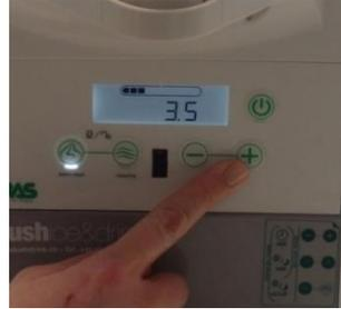
5. Die Konsistenz ist ab Werk auf Stufe 8 eingestellt, damit das Endprodukt die gewünschte Qualität erreicht. Um einen störungsfreien Betrieb der Maschine zu gewährleisten, verstellen Sie diese bitte nicht.
