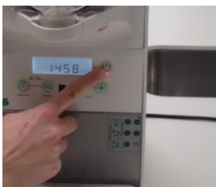
3. Drücken Sie die On-Taste zirka 3 Sekunden, bis die Maschine zu drehen beginnt.
